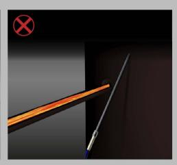
12) DO NOT LEAVE THE LANCE INSTALLED IN THE LANCE HOLDER ONCE YOU HAVE FINISHED LANCING AND DO NOT LEAVE THE LANCE CLOSE TO THE MOLTEN MATERIAL ONCE YOU HAVE FINISHED.
