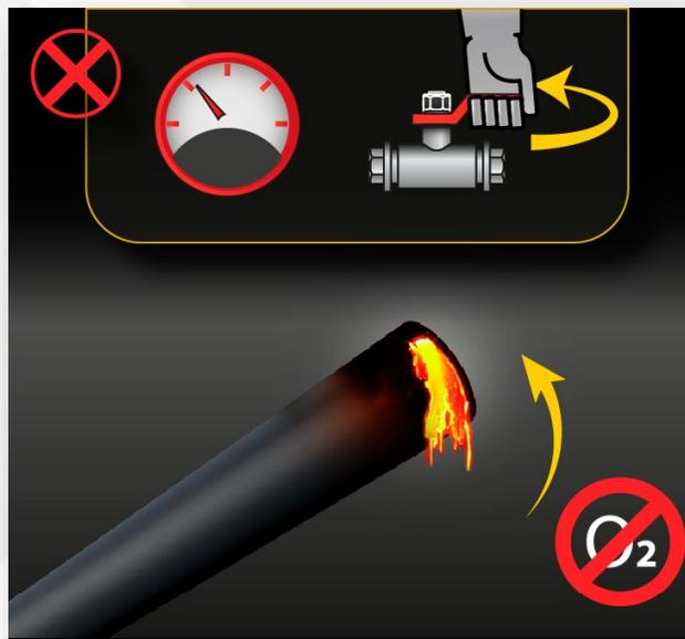
5) NO apagar la lanza térmica inclinándola hacia arriba.
