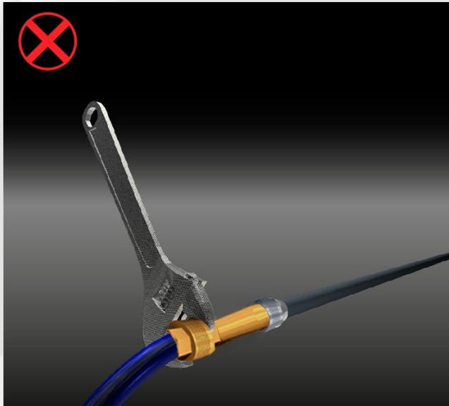
8) El operador NO debe manipular, intervenir ni instalar el portalanza en la red de oxígeno, sólo lo puede hacer el mecánico capacitado por Trefimet.
