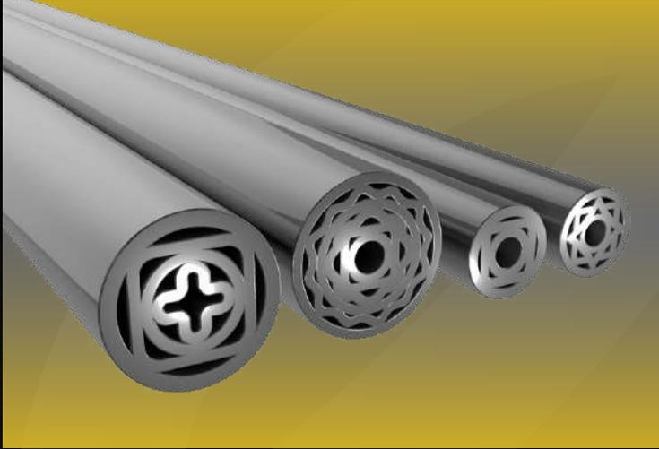
Mientras mayor sea el espesor del objeto a cortar, mayor debe ser el diámetro de la lanza. Así se logra evacuar el material fundido por los canales profundos, sin riesgo que se solidifique. También disminuye el riesgo de atasco de la lanza.
