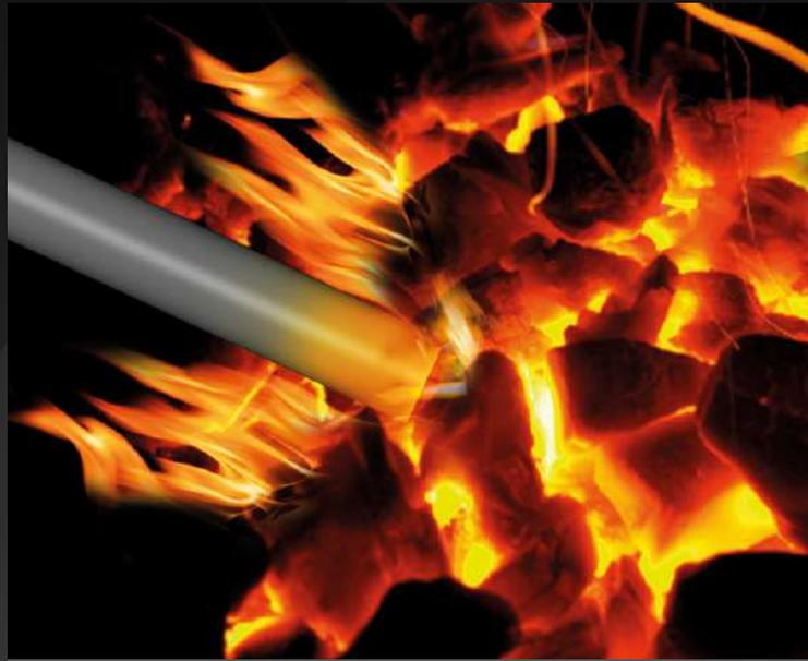
Este encendido se realiza con materiales combustibles como el carbón coque, madera, cartón, etc, aprovechando el oxígeno para acelerar la combustión. Para encender la lanza con este sistema se debe hacer tocar la punta de la lanza con el material combustible dejando pasar una baja cantidad de oxígeno.
